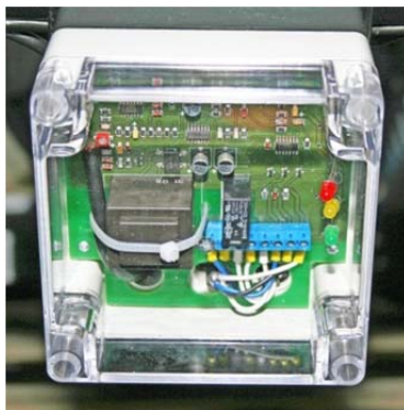
Рисунок 10- Блок контроля влажности фильтра-картриджа «Аквасейф»
