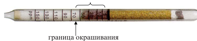
Рисунок 9 - Индикаторная трубка «Carbon monoxide 2/a-P» после проведения измерений (пример)
