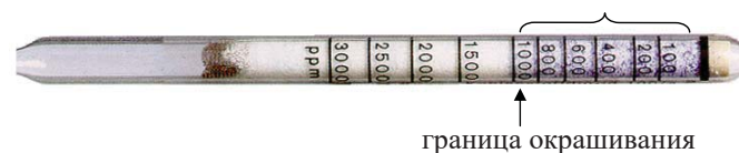
Рисунок 11 - Индикаторная трубка «Carbon dioxide 100/a-P» после проведения измерений (пример)
