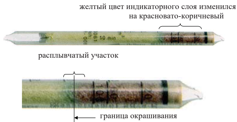
Рисунок 13 - Индикаторная трубка «Water vapour 20/a-P» после проведения 10-минутного измерения (пример)
