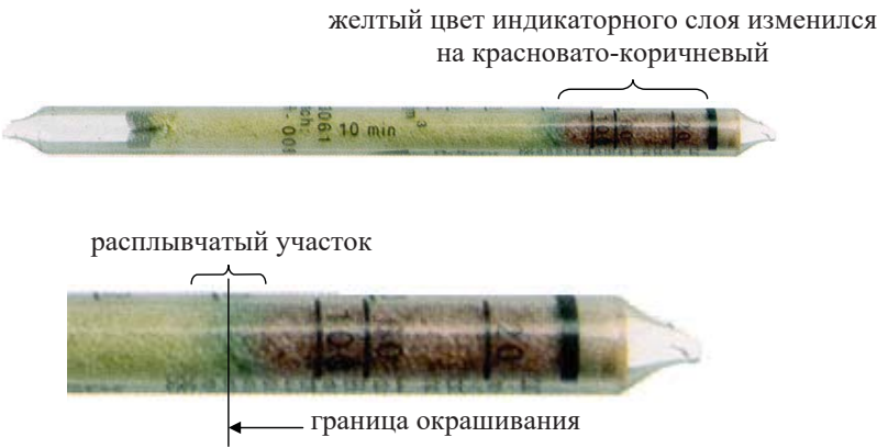
Рисунок 15 - Индикаторная трубка «Water vapour 20/a-P» после проведения 10-минутного измерения (пример)
