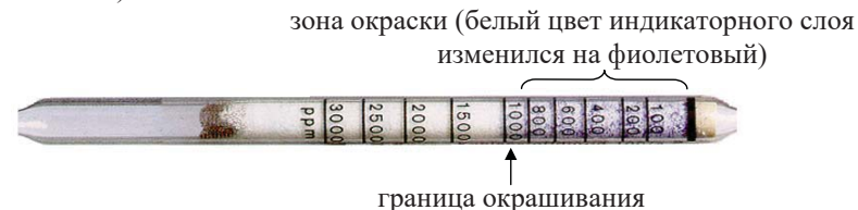
Рисунок 11 - Индикаторная трубка «Carbon dioxide 100/a-P» после проведения измерений (пример)
