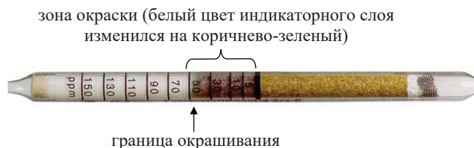
Рисунок 9 - Индикаторная трубка «Carbon monoxide 2/a-P» после проведения измерений (пример)
